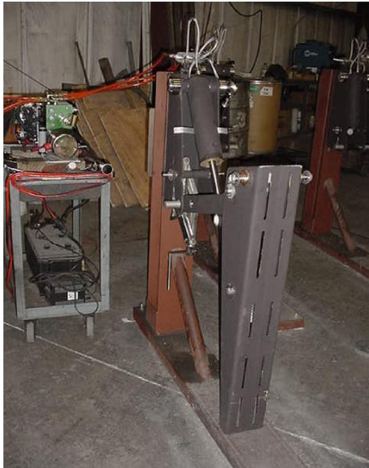
WITH A SLIGHT UPWARD LIFTING OF THE PLATFORM BRACKET, REMOVE THE 10-025 PIN AND THE 2ea FS303 NYLON WASHERS. LET THE END OF THE PLATFORM BRACKET REST ON THE GROUND.
